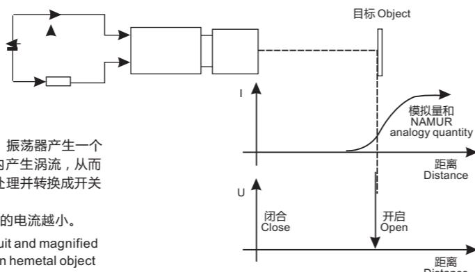
电感式接近开关的电流损耗，随着与金属目标距离的减小而减小。
