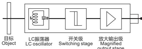
电感式接近开关由三大部分组成：振荡器、开关电路及放大输出电路。振荡器产生一个交变磁场。当金属目标接近这一磁场，并达到感应距离时，在金属目标内产生涡流，从而导致振荡器衰减，以至停振。振荡器振荡及停振的变化被后级放大电路处理并转换成开关信号，触发驱动控制器件，从而达到非接触式之检测目的。
